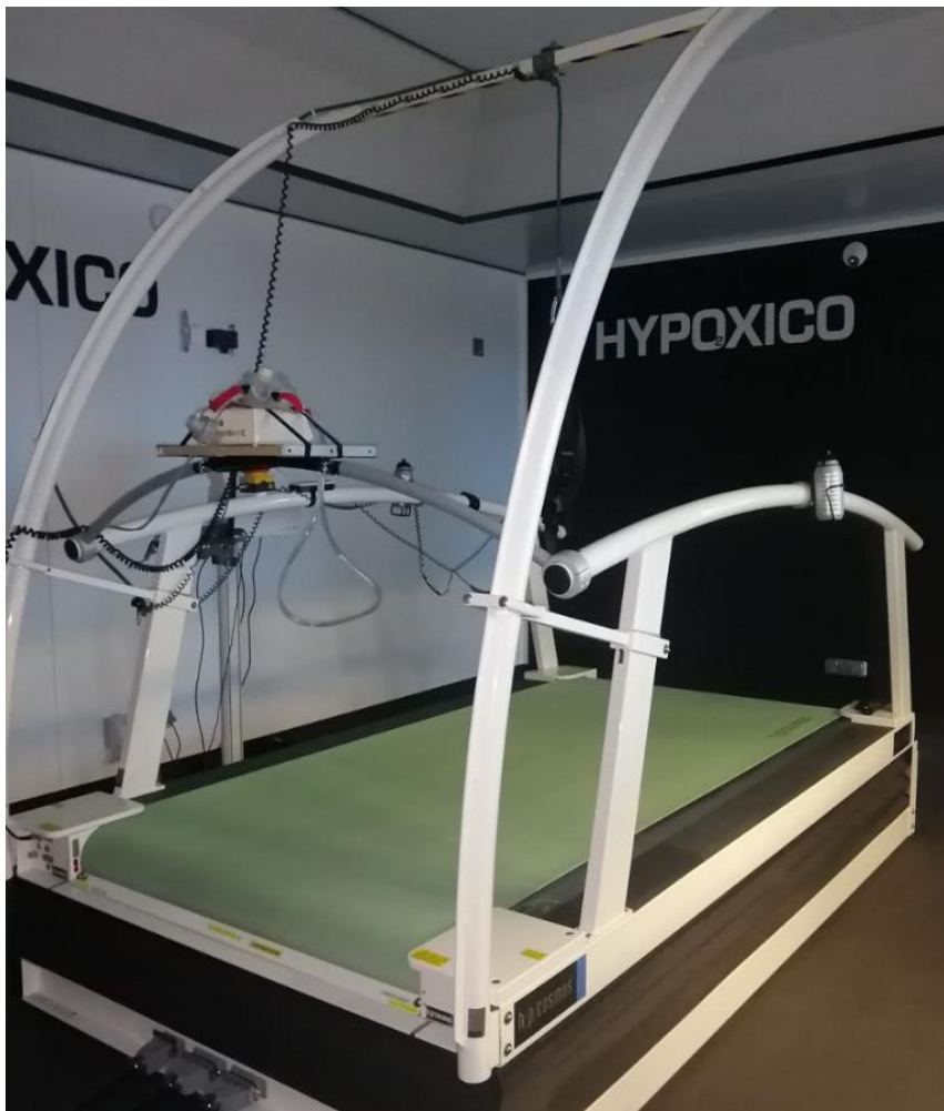
Камера климатическая лабораторная Hypoxico Clima 3000 с установленным тредбаном H/P Cosmos 250/125
